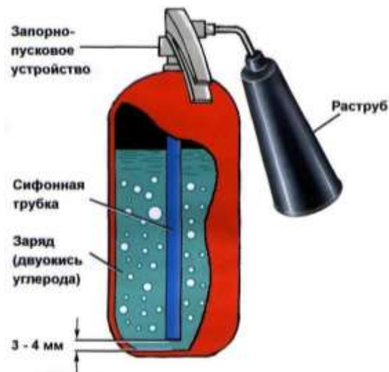
Рис. 3.9. Внутреннее строение углекислотных огнетушителей
