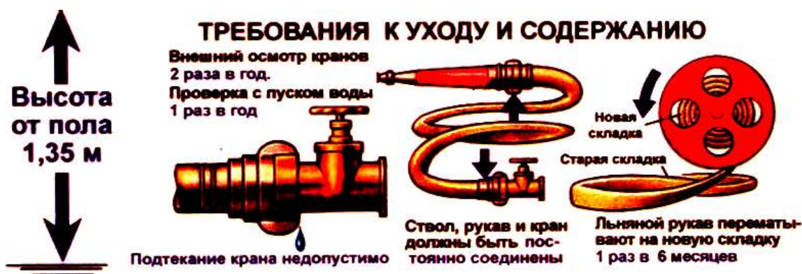
Рис. 3.7. Требования по уходу и содержанию внутреннего пожарного крана
