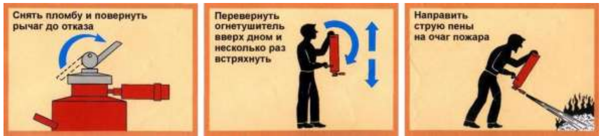
Рис. 3.17. Приведение в действие химического пенного огнетушителя
