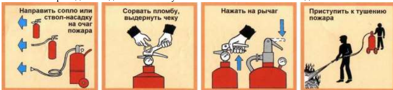
Рис. 3.24. Приведение в действие огнетушителя с газовым источником давления
