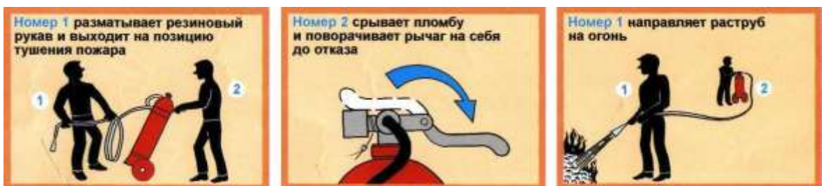
Рис. 3.13. Приведение в действие передвижного углекислотного огнетушителя
