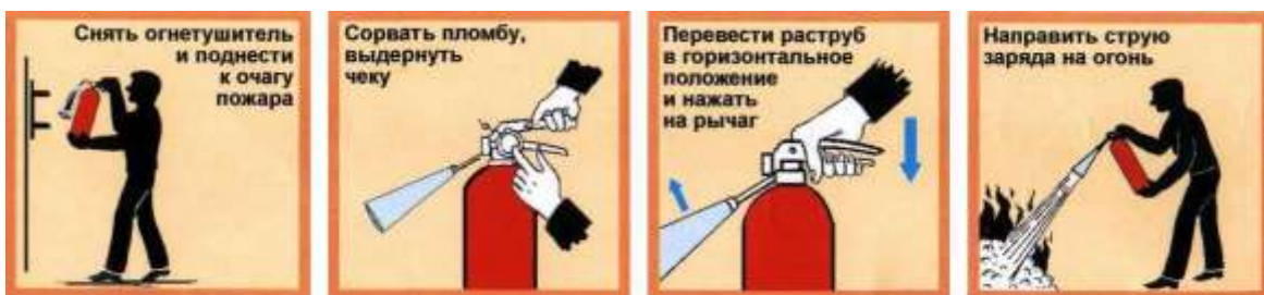
Рис. 3.12. Приведение в действие ручного углекислотного огнетушителя
