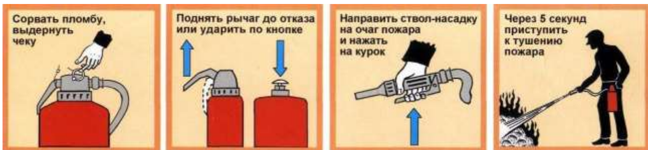
Рис. 3.24. Приведение в действие огнетушителя с газовым источником давления
