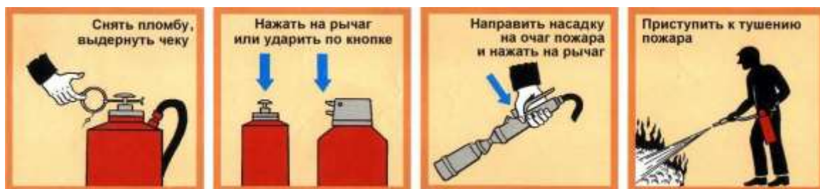
Рис.3.19. Приведение в действие воздушно-пенного огнетушителя
