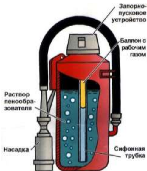
Рис. 3.18. Внутреннее строение воздушно-пенных огнетушителей
