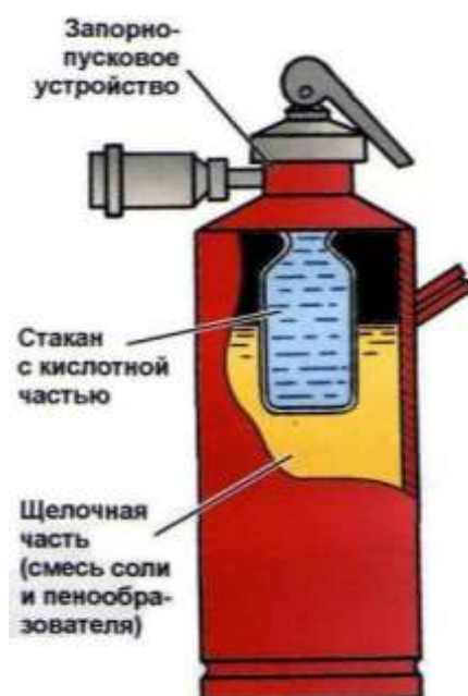
Рис. 3.16. Внутреннее строение химических пенных огнетушителей
